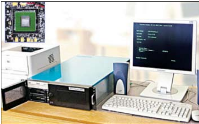
Рис.3. Микропроцессор "Эльбрус" (в левом верхнем углу) и вычислительный комплекс "Эльбрус-3М1" в серверном исполнении
